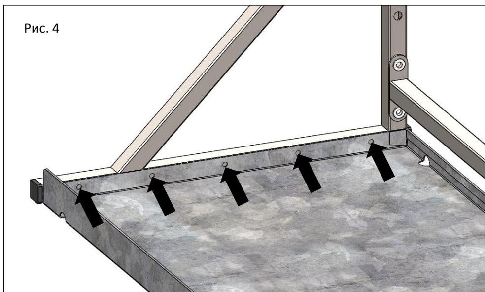
4.5 По выполненным отметкам просверлить отверстия диаметром 5,2 мм на внутренней стороне горизонтальных стоек рамы. Рис. 5
